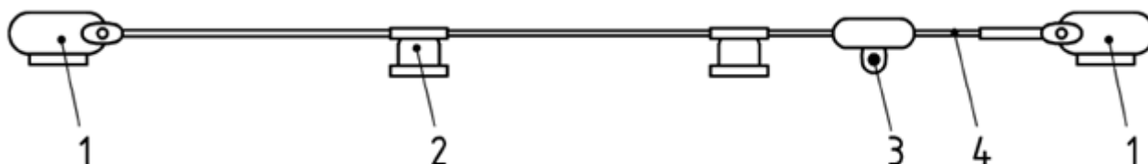
1 Anclaje terminal 2 Anclaje intermedio 3 Punto de anclaje móvil 4 Línea de anclaje flexible
