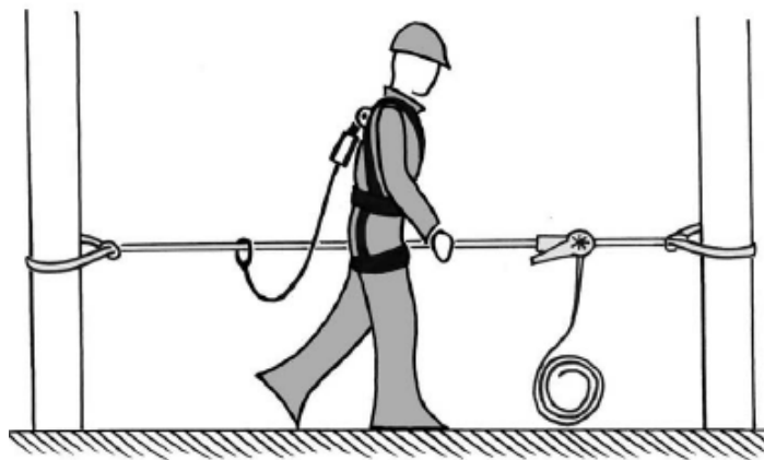
Línea de anclaje provisional de cinta
