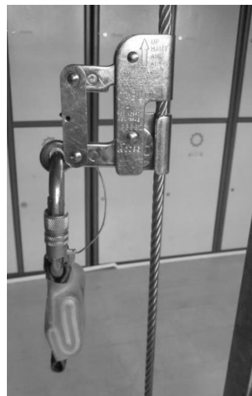
Línea rígida de cable
